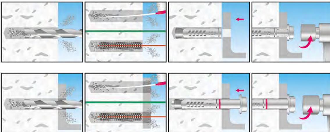
Nach der Reinigung des Bohrlochs den Dübel bündig hineinschieben und das Montageteil abschliessend auf den Dübel aufsetzen. Die Schraube fixiert die Montage durch das Anziehen, bei der die Hülse gespreizt wird.
